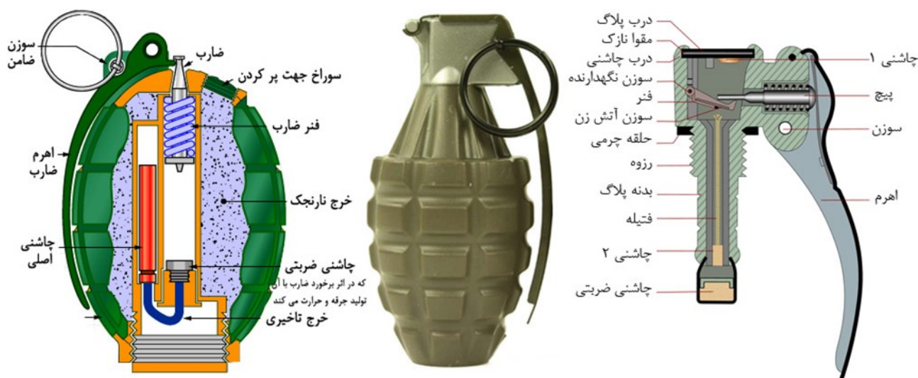
شکل ۵: اجزاء تشکیل دهنده ساختمان نارنجک [۳۰].
