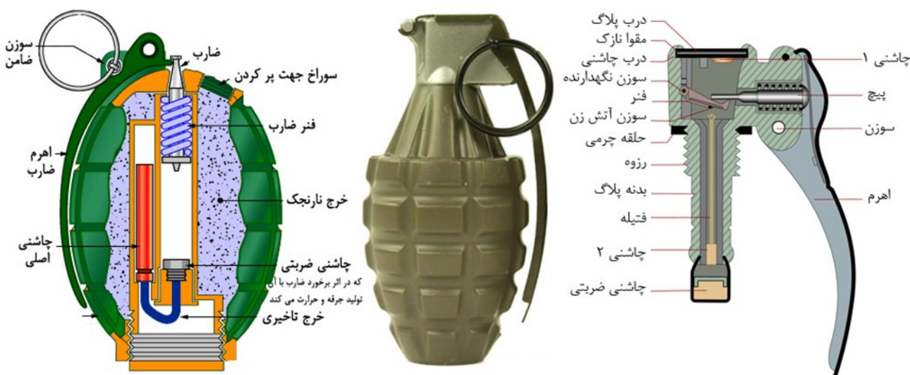
شکل ۵: اجزاء تشکیل دهنده ساختمان نارنجک [۳۰].
