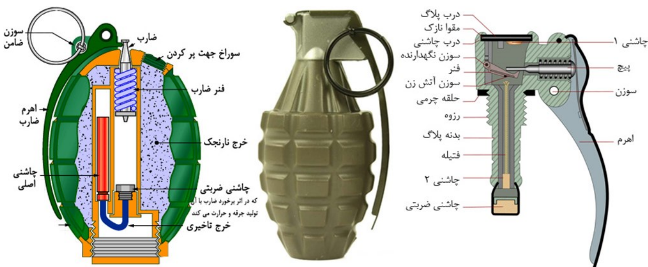
شکل ۵: اجزاء تشکیل دهنده ساختمان نارنجک [۳۰].
