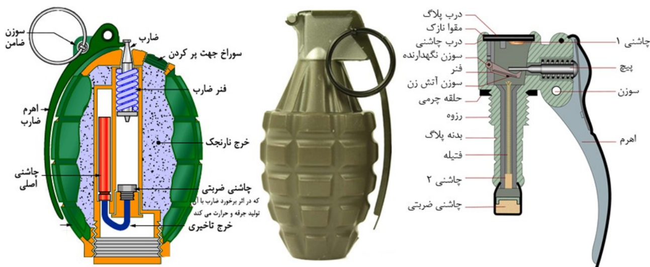
شکل ۵: اجزاء تشکیل دهنده ساختمان نارنجک [۳۰].
